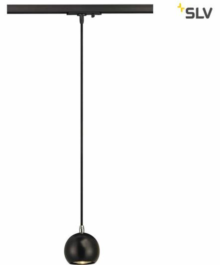
Hochvoltpendelleuchte LIGHT EYE in neuen Trendfarben mit passendem Adapter für das 1Phasen Hochvolt-Schienen-System. Die kugelförmige, aus Stahl und textilummanteltem Kabel gefertigte Leuchte ist durch den verbauten GU10 Sockel für Halogen- sowie LED-Leuchtmittel geeignet. Die mit einer Pendellänge von 150 cm versehene Leuchte kann optional mit einem Dekoring in schwarz, weiß oder chrom aufgewertet werden.
