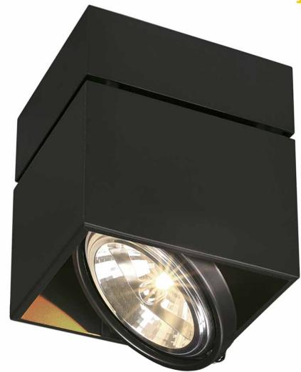
Die QRB Niedervoltversion der KARDAMOD Deckenleuchte ist aus hochwertigem Stahl gefertigt und verfügbar in den Gehäusefarben weiß, schwarz matt und silbergrau. Der Lampenhalter ist kardanisch schwenkbar und erlaubt so die individuelle Ausrichtung des Lichtkegels. KARDAMOD wird, dank des bereits eingebauten Transformators, fertig für den direkten Anschluss an 230V Netzspannung geliefert.
