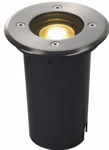
Die begehbare Hochvoltbodeneinbauleuchte SOLASTO 120 mit runder Edelstahlblende ist mit einer GU10 Kunststofffassung ausgestattet und somit speziell und ausschließlich für LED Lampen geeignet. Durch die Schutzart IP67 ist die Leuchte für den Außenbereich geeignet. Der elektrische Anschluss erfolgt direkt an 230V Netzspannung. Zur einfachen Montage befindet sich ein Einbautopf im Lieferumfang.
