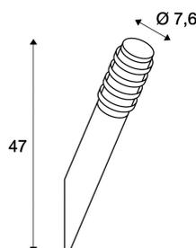
Die Wandleuchte der BIG NAILS PLUS Serie besteht durch Ihre Leuchtfläche bestehend aus opalen Acrylglasringen die in den Edelstahlkörper der Leuchte eingearbeitet sind. Durch Schutzart IP44 ist sie für den Außenbereich geeignet. Optional ist eine Verbindungsbox zum sicheren, elektrischem Anschluss im runden Leuchtschaft verfügbar. Der elektrische Anschluss der Leuchte erfolgt an 230V Netzspannung. Die BIG NAILS PLUS Serie beinhaltet des Weiteren Standleuchten und ist somit universell einsetzbar.
