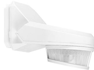
Bewegungsmelder mit Unterkriechschutz, potentialfreiem Schaltausgang und intelligenter Kleintier-Toleranz. 240° Erfassungsbereich für Montage an Wand oder Decke. Dreh- und neigbarer Sensorkopf für optimale Einstellung. Einfache Verdrahtung auf Sockel, Melder zum Aufklicken.
