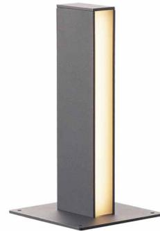
Indirekt abstrahlende Standleuchte H-POL SINGEL bestehend aus Aluminium und Kunststoff. Mit ihrer Schutzart IP55 ist sie für den Außenbereich geeignet. Durch die 8W LED eignet sich die Leuchte ideal als Wegeleuchte. Das Produkt ist zum Bodeneinbau und Durchverdrahtung vorgesehen. Zur optionalen Montage im Erdreich steht ein größerer Einbautopf zur Verfügung. Der Anschluss erfolgt an 230V Netzspannung, da der LED-Treiber bereits verbaut ist.
