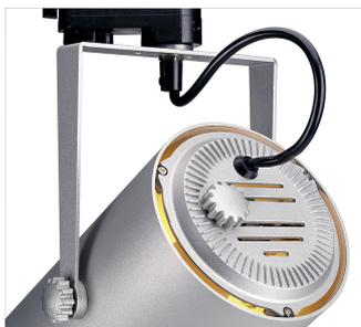
Dreh- und schwenkbarer Hochvoltstrahler EURO SPOT mit passendem Adapter für das 3Phasen Hochvolt-Schienen-System. Durch den im zylindrischen Aluminium Leuchtenkopf verbauten E27 Sockel ist die Leuchte für Energiespar- und LED-Leuchtmittel geeignet.
