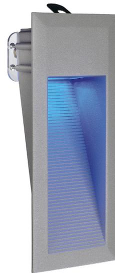
Aluminium Wandinbauleuchte der DOWNUNDER LED Serie. Die nicht sichtbar verbauten SMD LEDs geben ihr Licht indirekt an die zu beleuchtende Fläche ab. Dadurch wird zum Beispiel eine blendfreie Beleuchtung von Gehwegen ermöglicht. Der elektrische Anschluss erfolgt direkt an 230V Netzspannung. Durch die Schutzart IP44 ist die Leuchte für den Außenbereich geeignet. Die DOWNUNDER LED Serie beinhaltet des Weiteren Versionen mit anderen Formen sowie Gehäuse- und Lichtfarben.
