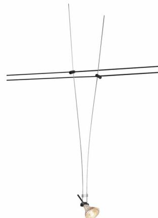
SEILLEUCHE für das Niedervolt Seil-System dessen Halogen- sowie LED-Leuchtmittel kompatible GX5,3 Fassung an zwei Stahlseilen befestigt ist. Der kompatible Seilabstand liegt bei 15,5cm und ist in mehreren Farben erhältlich.
