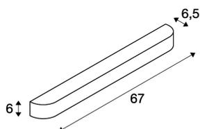
Die ARLINA T5 24 Wandleuchte ist aus gebürstetem Aluminium gefertigt und mit einer satinierten Glasabdeckung versehen. Konzipiert für den Einsatz energiesparender T5 Leuchtstoffröhren ist die ARLINA T5 24 Wandleuchte, bereits mit eingebautem Vorschaltgerät ausgestattet, fertig für den direkten Anschluss an 230V Netzspannung.
