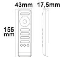
**112451 | Universal-Push PWM-Dimmer für LED Spots / Stripes, 1 Kanal, 12-24V 8A, 36-48V 6A**
