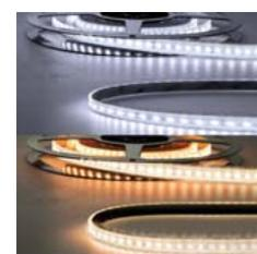
Bei 3-polige weißdynamischen Flexbändern\* regelt der zwischen Trafo und Lichtquelle platzierte weißdynamische PWM CCT-Controller dynamisch die Farbtemperatur und Leistung zwischen dem kaltweißen und dem warmweißen Kanal auf gleichbleibendem Helligkeitsniveau. Bei Einstellung eines Mischverhältnisses zum Beispiel auf Neutralweiß regelt der Controller den warmweißen Kanal auf 50% und den kaltweißen Kanal ebenfalls auf 50%.
