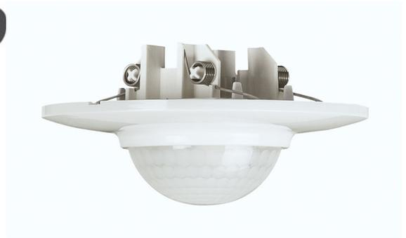
Master/Slave-Präsenzmelder mit Federklemmenadapter für die schnelle Montage in abgehängten Decken. Konstantlichtregelung für 2 Zonen, 1 sekundäre Zone (ON/OFF), HLK, Helligkeitsschwelle und Nachlaufzeit im Betrieb veränderbar, Standby-Licht, Voll- und Halbautomatikmodus.
