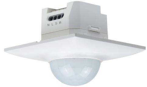
Master-Präsenzmelder für DALI-Systeme (Broadcast). Konstantlichtregelung für 1 Zone. Einfache Inbetriebnahme über App, Fernbedinung oder Regler. Max. 10 Slave-Melder werden über ein Steuerkabel verdrahtet.
