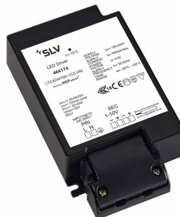
Dimmbarer LED-Treiber mit 700mA Konstantstrom und einer Leistung von 40 Watt inklusive Zugenlastung. Der Anschluss der LEDs muss in Reihenschaltung erfolgen. Sekundärseitig verfügt der Treiber zwecks Dimmbarkeit über eine 1-10V Schnittstelle.
