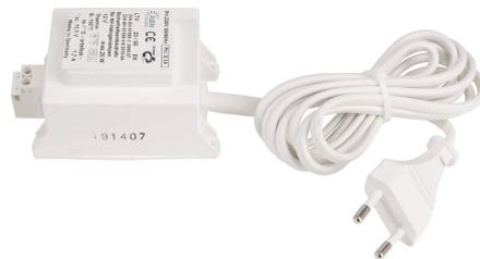
Gewickelte, vakuumvergossene und daher sehr robuste Trafos, dimmbar mittels Phasenanschnittsdimmer. Konventionelle Trafos sollten min. zu 50% ausgelastet werden, um eine optimale Funktion der Leuchtmittel zu gewährleisten. Diese Trafos besitzen einen Thermoschalter.
