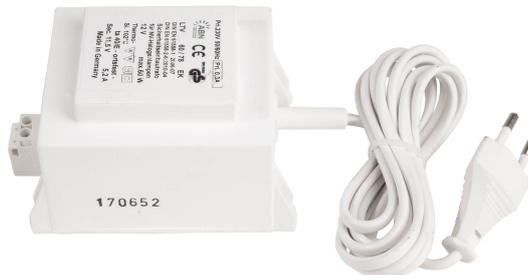
Gewickelte, vakuumvergossene und daher sehr robuste Trafos, dimmbar mittels Phasenanschnittsdimmer. Konventionelle Trafos sollten min. zu 50% ausgelastet werden, um eine optimale Funktion der Leuchtmittel zu gewährleisten. Diese Trafos besitzen einen Theroschalter.
