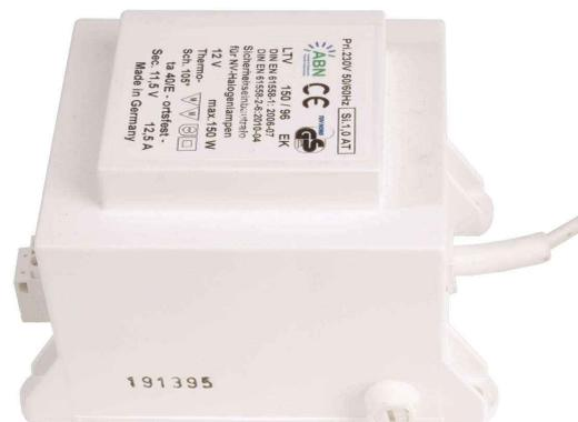
Gewickelte, vakuumvergossene und daher sehr robuste Trafos, dimmbar mittels Phasenanschnittsdimmer. Konventionelle Trafos sollten min. zu 50% ausgelastet werden, um eine optimale Funktion der Leuchtmittel zu gewährleisten. Diese Trafos besitzen einen Thermo-Schalter. Trafos ab 150VA verfügen über eine zusätzliche Sicherung.
