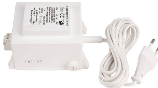
Gewickelte, vakuumvergossene und daher sehr robuste Trafos, dimmbar mittels Phasenanschnittsdimmer. Konventionelle Trafos sollten min. zu 50% ausgelastet werden, um eine optimale Funktion der Leuchtmittel zu gewährleisten. Diese Trafos besitzen einen Theroschalter.
