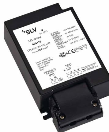
Dimmbarer LED-Treiber mit 1000mA Konstantstrom und einer Leistung von 40 Watt inklusive Zugenlastung. Der Anschluss der LEDs muss in Reihenschaltung erfolgen. Sekundärseitig verfügt der Treiber zwecks Dimmbarkeit über eine 1-10V Schnittstelle.
