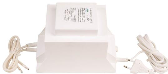
Gewickelte, vakuumvergossene und daher sehr robuste Trafos, dimmbar mittels Phasenanschnittsdimmer. Konventionelle Trafos sollten min. zu 50% ausgelastet werden, um eine optimale Funktion der Leuchtmittel zu gewährleisten. Diese Trafos besitzen einen Thermoschalter. Trafos ab 150VA verfügen über eine zusätzliche Sicherung.
