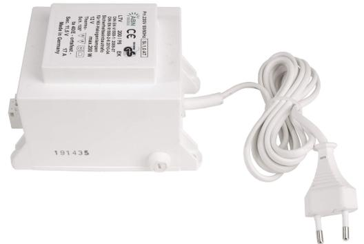
Gewickelte, vakuumvergossene und daher sehr robuste Trafos, dimmbar mittels Phasenanschnittsdimmer. Konventionelle Trafos sollten min. zu 50% ausgelastet werden, um eine optimale Funktion der Leuchtmittel zu gewährleisten. Diese Trafos besitzen einen Thermoschalter. Trafos ab 150VA verfügen über eine zusätzliche Sicherung.
