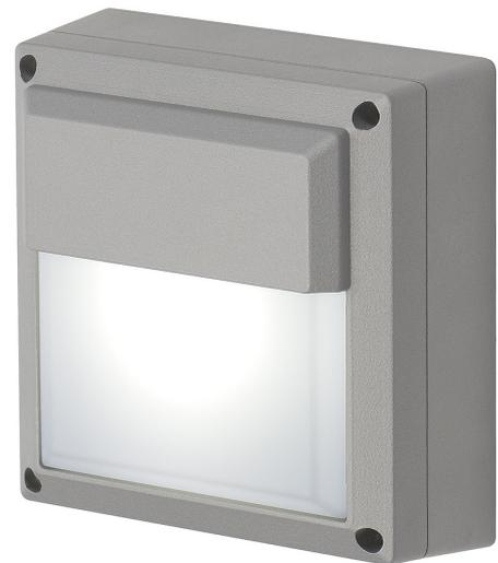
Die quadratisch aus Aluminium gefertigte Wandanbauleuchte WL 172 gibt ihr Licht durch eine opale PC Leuchtfläche ab. Durch die Schutzart IP44 ist die Leuchte für den Außenbereich geeignet. Der elektrische Anschluss der in mehreren Farbversionen verfügbaren Leuchte erfolgt direkt an 230V Netzspannung.
