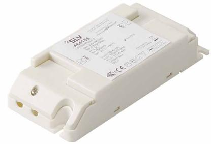
Dimmbarer LED-Treiber mit 700mA Konstantstrom und einer Leistung von 21-30 Watt. Dimmbar über Phasenabschnitt oder Phasenanschnitt. Der Anschluss der LEDs muss in Reihenschaltung erfolgen.
