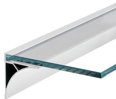
GLENOS Regal-Profil in 60 cm Länge zur Montage von Glasböden in 0,8 cm Dicke und max. 18 cm breit mit darunter befestigtem LED-Strip. Glas und LED Strip nicht im Lieferumfang enthalten. Empfohlen zur Befestigung mit 3 Senkkopfschrauben.
