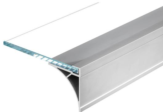
GLENOS Regal-Profil in 60 cm Länge zur Montage von Glasböden in 0,8 cm Dicke und max. 18 cm breit mit darunter befestigtem LED-Strip. Glas und LED Strip nicht im Lieferumfang enthalten. Empfohlen zur Befestigung mit 3 Senkkopfschrauben.
