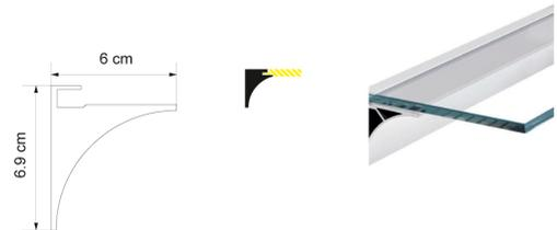
GLENOS Regal-Profil in 200 cm Länge zur Montage von Glasböden in 0,8 cm Dicke und max. 18 cm breit mit darunter befestigtem LED-Strip. Glas und LED Strip nicht im Lieferumfang enthalten. Empfohlen zur Befestigung mit 8 Senkkopfschrauben.
