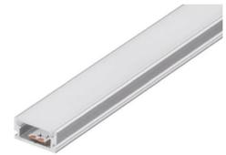
GLENOS Regal-Profil in 100 cm Länge zur Montage von Glasböden in 0,8 cm Dicke und max. 18 cm breit mit darunter befestigtem LED-Strip. Glas und LED Strip nicht im Lieferumfang enthalten. Empfohlen zur Befestigung mit 4 Senkkopfschrauben.
