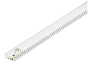
Ultraflaches GLENOS Linear-Profil 1809 in 1 m Länge exklusive Abdeckung zur Montage von LED Strips bis 12 mm Breite. Das in schwarz matt, weiß matt und aluminium eloxiert erhältliche Profil ist in Kombination mit den entsprechenden Haltern 213849 zur Mont
