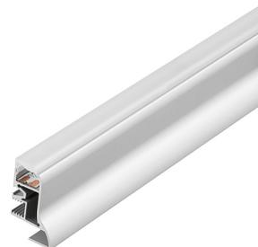
Die GLENOS Fußleiste in 1 m Länge inklusive Abdeckung für LED Strips bis 12 mm Breite erzeugt einen besonderen Lichteffect auf der Wand. Die optional erhältlichen Dübel sind geeignet zur Befestigung an Mauerwänden, alternativ kann die Fußleiste einfach aufgeklebt werden.
