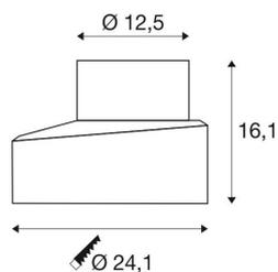
Der in drei Größen verfügbare Bodeneinbautopf für die DASAR® PREMIUM Serie eignet sich für die einfache und schnelle Bodeneinbaumontage.
