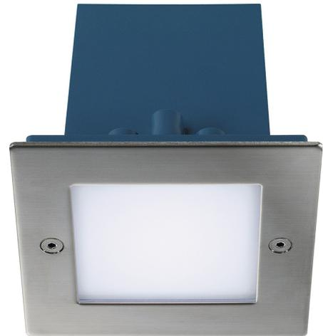
Bei der aus witterungsbeständigem Edelstahl gefertigten Wandeinbauleuchte FRAME OUTDOOR 16 werden die verbauten SMD LEDs von einer satinierten Glasscheibe abgedeckt. Durch die Schutzart IP44 ist die in mehreren Lichtfarben verfügbare Leuchte für den Außenbereich geeignet. Der elektrische Anschluss erfolgt durch das verbaute Netzteil direkt an 230V Netzspannung. Zur einfachen Montage befindet sich ein Einbautopf im Lieferumfang.
