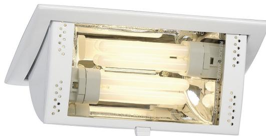
Das TC DL Deckeneinbaudownlight für gewerbliche Anwendungen und solche mit hohen Anforderungen an klare Lichteigenschaften. Verfügbar in den Gehäusefarben weiss und silbergrau ist es für die Aufnahme zweier 13W Energiesparlampen des Typs TC-DE für G24q-1 Fassungen vorbereitet. Dank des bereits eingebauten, elektronischen Vorschaltgerätes, ist das TC DL Downlight fertig für den direkten Anschluss an 230V Netzspannung.
