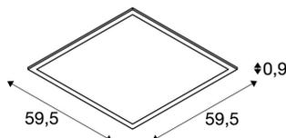
Mit dem in mehreren Lichtfarben erhältlichen LED PANEL 600 für Rasterdecken, bieten wir eine moderne und raumsparende Lösung für eine effiziente Art der Grundbeleuchtung. Mit diesem Produkt erreichen Sie ein angenehmes, homogenes und blendfreies Beleuchtungsempfinden. Hier wird ein Blendwinkel unter 19° erreicht.
