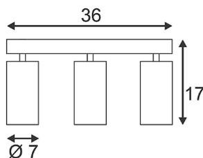
Die ASTO TUBE 3 Deckenleuchte ist aus Aluminium gefertigt und wahlweise verfügbar in weißer oder aluminium gebürsteter Lackierung. Der lichtundurchlässige, zylindrische Leuchtenkorpus ist sowohl dreh- als auch schwenkbar und sorgt für blendfreies Licht der zum Einsatz gebrachten GU10 Hochvolt Halogen oder LED Leuchtmittel. ASTO TUBE 3 ist fertig für den direkten Anschluss an 230V Netzspannung.
