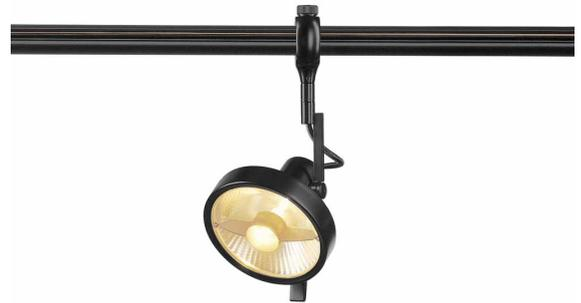
Dreh- und schwenkbarer Hochvoltstrahler YOKI mit passendem Adapter für das EASYTEC II Schienen-System. Die aus Aluminium gefertigte Leuchte ist durch den verbauten GU10 Sockel für Halogen- sowie LED-Leuchtmittel geeignet. Im Lieferumfang der in mehreren Farbversionen verfügbaren Leuchte befindet sich ein zu der Leuchte farblich passender Dekoring zum Aufsetzen auf ein Leuchtmittel mit 11,1 cm Durchmesser.+
