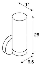
Die Hochvolt Wandleuchte WL 105 wurde aus verchromtem Aluminium mit Stahl- und Glaselementen gefertigt und ist mit einem weiteren, satinierten Glaszylinder ausgestattet. Für die Aufnahme von Allgebrauchs- oder Energiesparlampen des Typs E14 vorbereitet ist die WL 105 Wandleuchte fertig für den direkten Anschluss an 230V Netzspannung. Darüber hinaus erlaubt die Schutzart IP44 die Montage in Feuchträumen.
