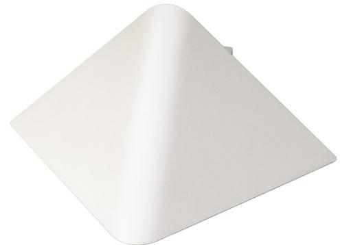
Die aufwendig konstruierte Wandanbauleuchte TRIANGLE R7s ermöglicht durch die besondere Formgebung des Gehäuses den Einsatz von Halogen-Stablampen. Somit ist die in mehreren Farben verfügbare Leuchte vielen Beleuchtungsanforderungen gewachsen. Der elektrische Anschluss erfolgt direkt an 230V Netzspannung. Durch die Schutzart IP44 ist die Leuchte für den Außenbereich geeignet.
