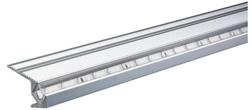
Aluminiumprofil zur Montage an Treppen oder sonstigen Kanten. In die eingearbeitete Nut kann das mit LEDs bestückte Leerrohr eingelegt werden.
