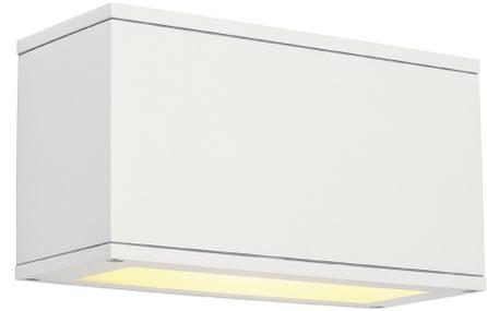
Einflammige Wandanbauleuchte THEOS 101 bestehend aus Aluminium und satiniertem Glas welches den Lichtauslass abdeckt. Durch Schutzart IP44 für den Außenbereich geeignet. Der elektrische Anschluss der in mehreren Farbversionen verfügbaren Leuchte erfolgt direkt an 230V Netzspannung.
