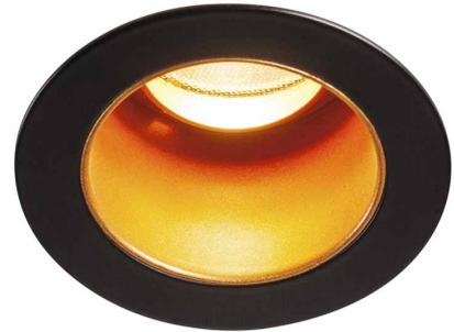
Der starre LED Einbauspot TRITON MINI wurde aus Aluminium hergestellt und ist eine LED-Lichtlösung für Anwendungen, bei denen punktuelle Akzentbeleuchtung und geringe Einbautiefe benötigt werden. Die warmweiße Power LED sorgt für die benötigte Beleuchtungsstärke. Zum Betrieb des Spots wird ein passender Konstantstromtreiber mit 350mA benötigt. Die Lampen können in der Leuchte nicht ausgetauscht werden.
