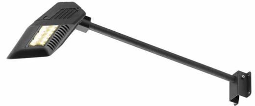
Die leistungsstarke Displayleuchte TODAY besteht aus lackiertem Aluminium welches die verbaute LED abdeckt. Der am geraden Ausleger montierte Leuchtenkopf ist schwenkbar. Durch die Schutzart IP55 ist sie für den Außenbereich geeignet. Der elektrische Anschluss der in weiß und schwarz verfügbaren Leuchte erfolgt an 230V Netzspannung. Diese Leuchte enthält eingebaute, leistungsstarke LED-Lampen mit 29W.
