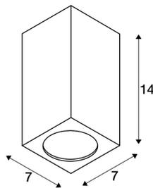
Deckenleuchte der THEO Serie gefertigt aus Aluminium und Glas welches das Leuchtmittel abdeckt. Durch die Schutzart IP23 ist sie für den Außenbereich geeignet. Der elektrische Anschluss der in mehreren Farbversionen verfügbaren Leuchte erfolgt an 230V Netzspannung. Die THEO Serie beinhaltet des Weiteren Wandleuchten und ist somit universell einsetzbar.
