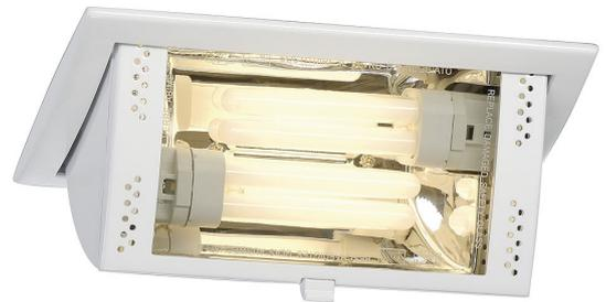
Das TC DL Deckeneinbaudownlight für gewerbliche Anwendungen und solche mit hohen Anforderungen an klare Lichteigenschaften. Verfügbar in den Gehäusefarben weiss und silbergrau ist es für die Aufnahme zweier 26W Energiesparlampen des Typs TC-DE für G24q-3 Fassungen vorbereitet. Dank des bereits eingebauten, elektronischen Vorschaltgerätes, ist das TC DL Downlight fertig für den direkten Anschluss an 230V Netzspannung.
