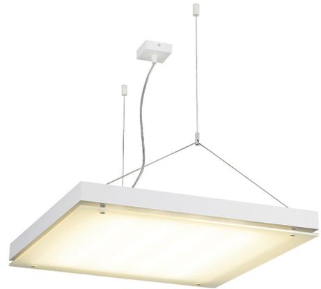
Die T5 GRILL Pendelleuchte ist eine professionelle Leuchte für die Aufbaumontage. Hinter dem satinierten Acrylglas, welches auf einem rechteckigen, weiss lackierten Rahmen montiert ist, befinden sich vier G5 Lampenhalter zur Aufnahme von T5 Leuchtstoffröhren mit je 24W Leistung. Dank der bereits eingebauten, elektronischen Vorschaltgeräte ist die T5 GRILL Pendelleuchte fertig für den direkten Anschluss an 230V Netzspannung.
