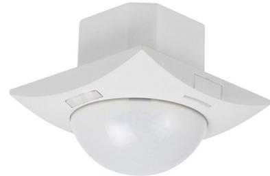
Präsenzmelder mit erhöhtem Erfassungsbereich und externem Tastereingang. 1 Lichtkanal plus 1 HLK Kanal sowie Voll- und Halbautomatikmodus. Die Schaltschwelle (Lux) kann nur für den Lichtkanal (Relais 1) gewählt werden. HLK (Relais 2) ist immer aktiv bei Präsenz.
