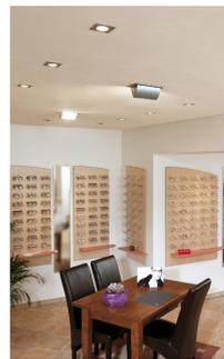
Die schwenkbare Niedervolt Einbauleuchte SQUARE QR-C51 ist erhältlich in den Gehäusefarben weiß, chrom, chrom matt, titan und silbergrau und erlaubt die individuelle Ausrichtung des gewünschten Lichtkegels. Zum Betrieb der Einbauleuchte wird ein passender Transformator mit 12V Wechselspannung benötigt.
