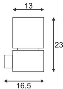
Die Wandaufbauleuchte der SQUARE Serie besteht aus gebürstetem Aluminium und einem opalen Acryl-Quader, der das Leuchtmittel beinhalten. Durch die Schutzart IP44 ist sie für den Außenbereich geeignet. Der elektrische Anschluss erfolgt an 230V Netzspannung. Die SQUARE Serie beinhaltet des Weiteren Decken- und Standleuchten und ist somit universell einsetzbar.
