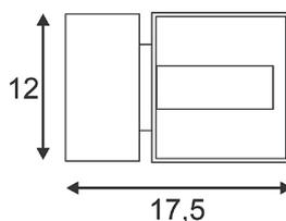
Aus Aluminium gefertigte, würfelförmige Wandleuchte. Das satinierte, freistehende Leuchtmittelschutzglas ist im drehbarem Kopf der Leuchte durch das Gehäuse eingefasst. Durch Schutzart IP44 auch für den Außenbereich geeignet. Der elektrische Anschluss erfolgt direkt an 230V Netzspannung. Ergänzend kann die Installation um entsprechende Standleuchten der Serie erweitert werden.
