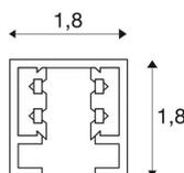
Aluminium Trägerschiene des D-TRACK Hochvolt 2Phasen-Aufbauschiene-Systems. Die Montage kann durch die im Profil vorhandenen Bohrungen direkt an Wand oder Decke erfolgen. Die Aufbauversion dieses Systems ist in mehreren Farben und Längen verfügbar.
