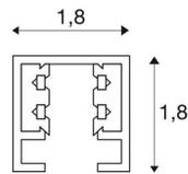
Aluminium Trägerschiene des D-TRACK Hochvolt 2Phasen-Aufbauschiene-Systems. Die Montage kann durch die im Profil vorhandenen Bohrungen direkt an Wand oder Decke erfolgen. Die Aufbauversion dieses Systems ist in mehreren Farben und Längen verfügbar.
